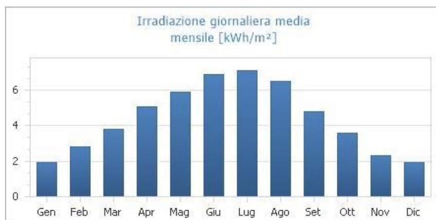
Irradiazione giornaliera media mensile sul piano orizzontale [kWh/m<sup>2</sup>] - Fonte dei dati: UNI 10349:2016 - Stazione di rilevazione: Fitterizi
