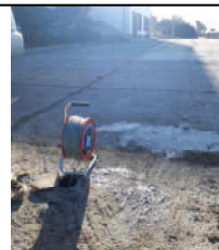
LETTURA LIVELLO PIEZOMETRICO
