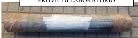
CAMPIONE DI TERRENO PER PROVE DI LABORATORIO
