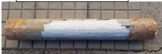
CAMPIONE DI TERRENO PER PROVE DI LABORATORIO
