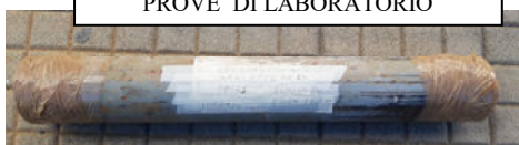
CAMPIONE DI TERRENO PER PROVE DI LABORATORIO
