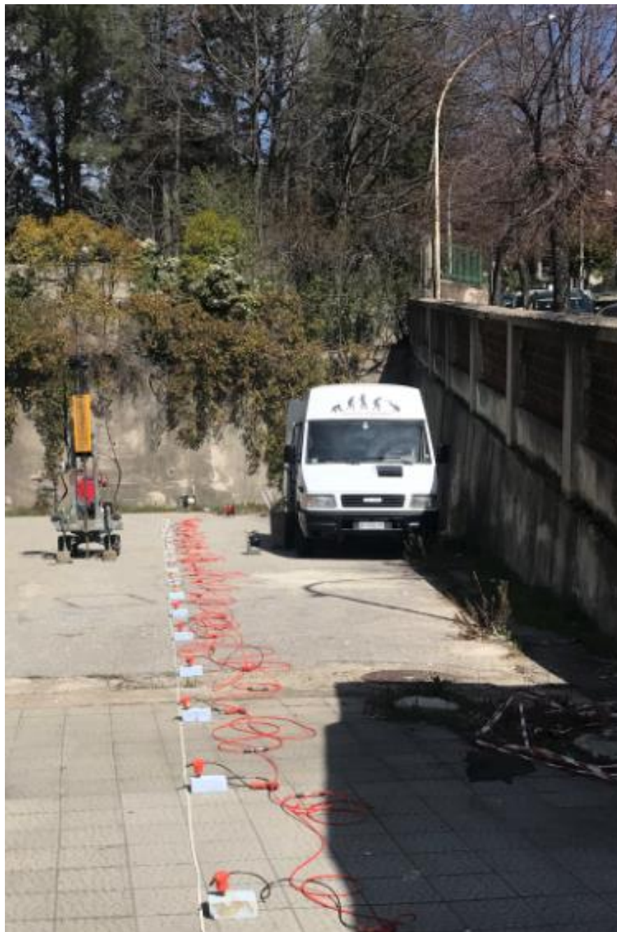
Fig. 3 – Sismica a rifrazione
