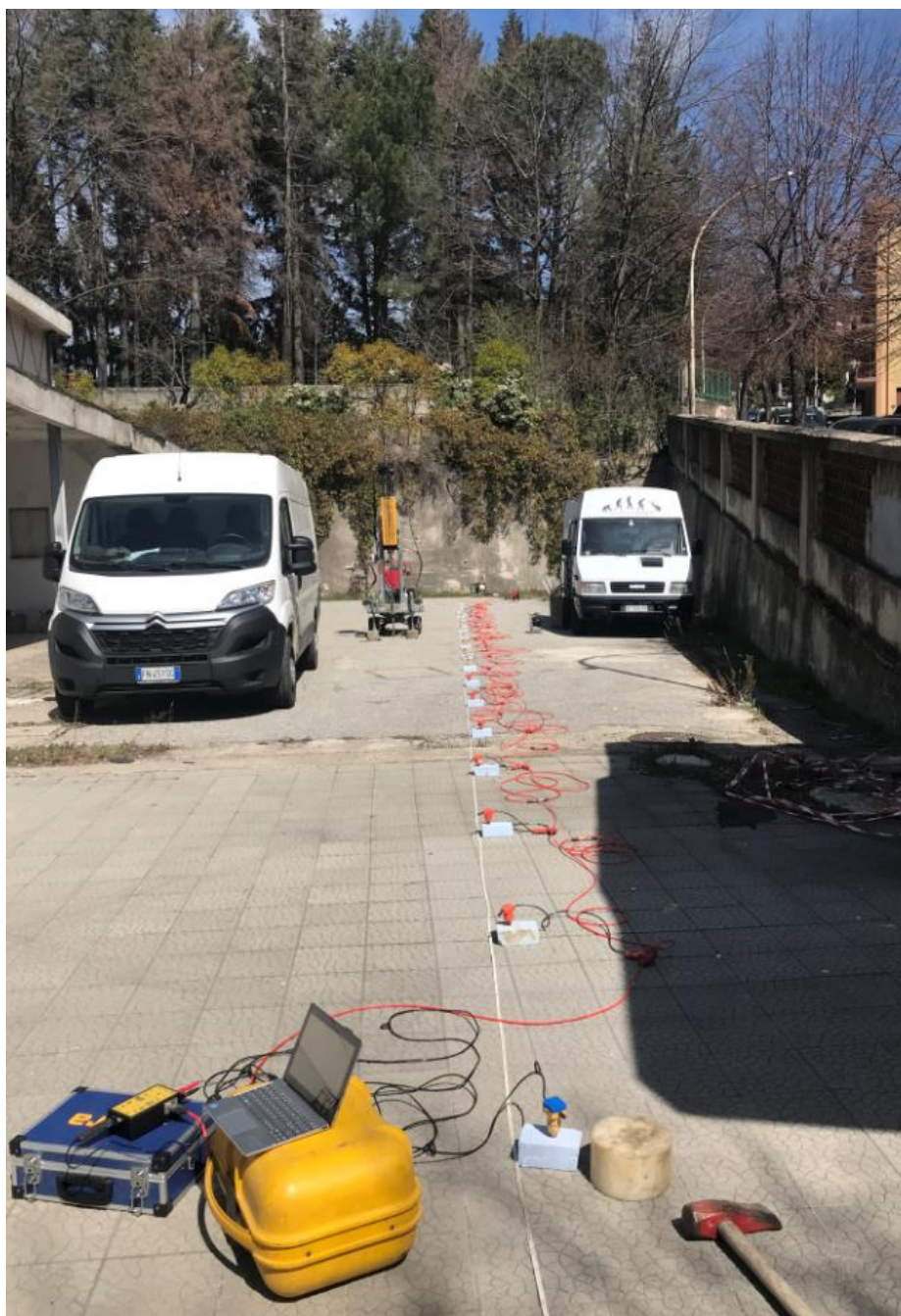
Fig. 4 – Acquisizione MASW in situ
