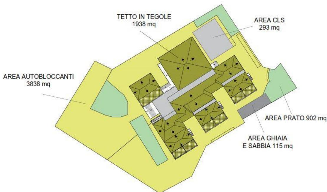
**Elaborato grafico/estratti di planimetria con individuazione delle aree esterne e delle coperture ombreggiate alle ore 12:00 del 21 Giugno:**
