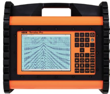
La sorgente sismica è costituita da una massa battente (mazza dal peso di 8kg) che batte su una piastra di alluminio. Il martello funge contemporaneamente da starter poiché collegato a mezzo di trigger al sismografo. Le oscillazioni del suolo sono state rilevate da 24 geofoni verticali da 4.5 Hz secondo la geometria di seguito riportata:
