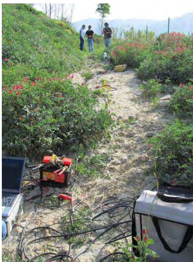
Figura 4: Ubicazione stendimento di tipo Masw
