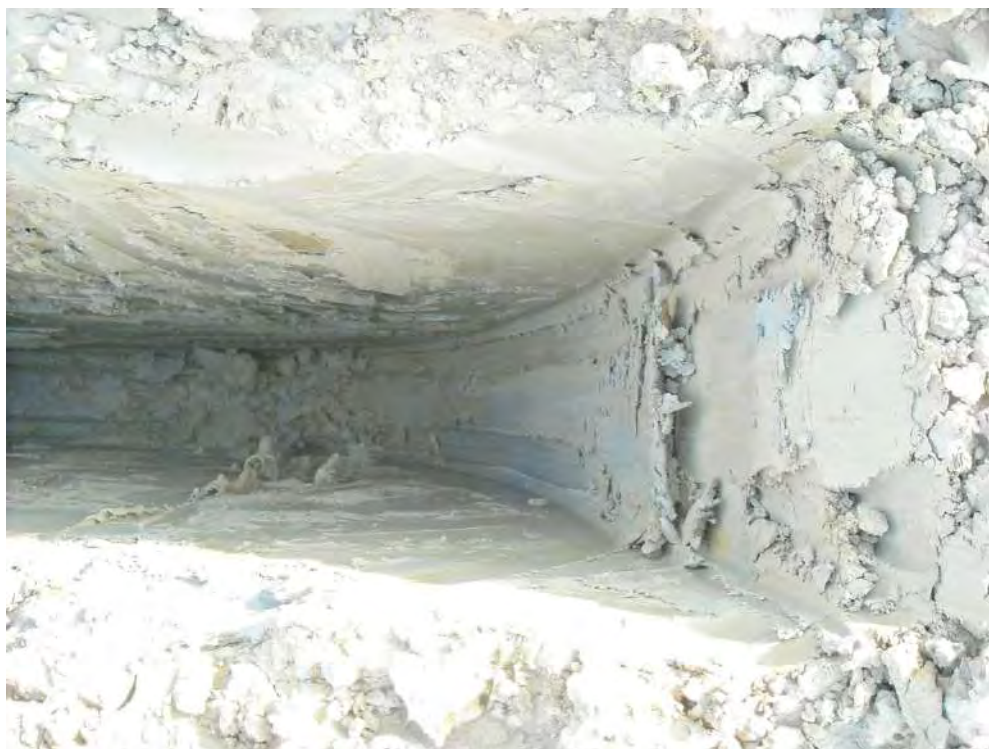
Foto 13: Scavo esplorativo eseguito a circa 20 m dall'impronta della struttura in progetto. Risultano evidenti le argille limose di colore grigiastro.
