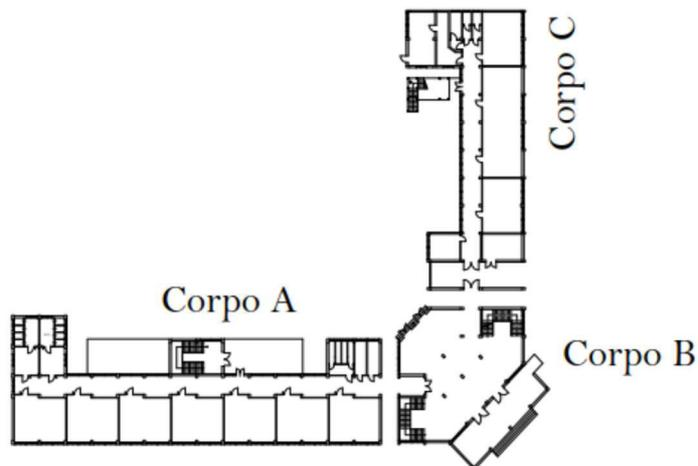
Per il **corpo A1** si procederà a rimuovere le parti di pavimento rimaste e si rifarà l'intero pavimento, inoltre verrà rifatto interamente l'impianto idrico dei bagni, l'impianto termico ed elettrico. Verranno ricreate le pareti interne precedentemente demolite per consentire i lavori di adeguamento e verrà eseguito l'intonaco e la tinteggiatura delle pareti. Verranno posizionate le nuove porte.
