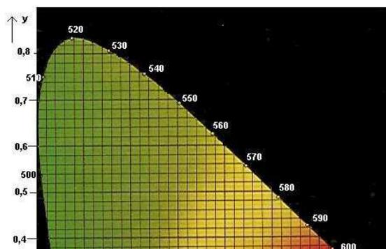
Figura 4 – Diagramma cromatico CIE 1931
