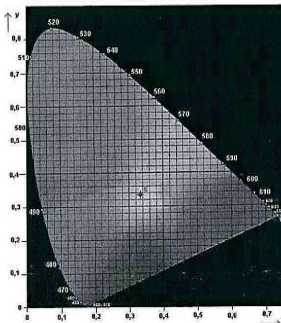
Figura 4 – Diagramma cromatico CIE 1931
