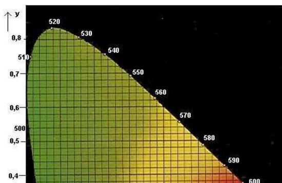
Figura 4 – Diagramma cromatico CIE 1931
